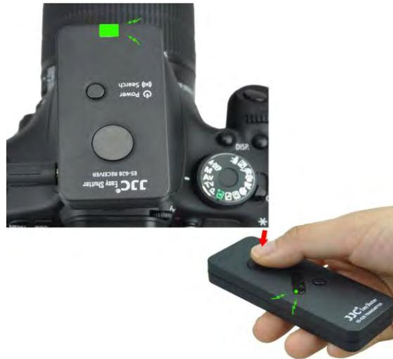
2. Drücken Sie die Taste ganz nach unten, während Sie die Shutter-Taste am Transmitter gedrückt halten, bis die rote LED am Transmitter blinkt. Lassen Sie dann die Taste los und der Empfänger verriegelt die Shutter-Taste für die Serienbildaufnahme.
