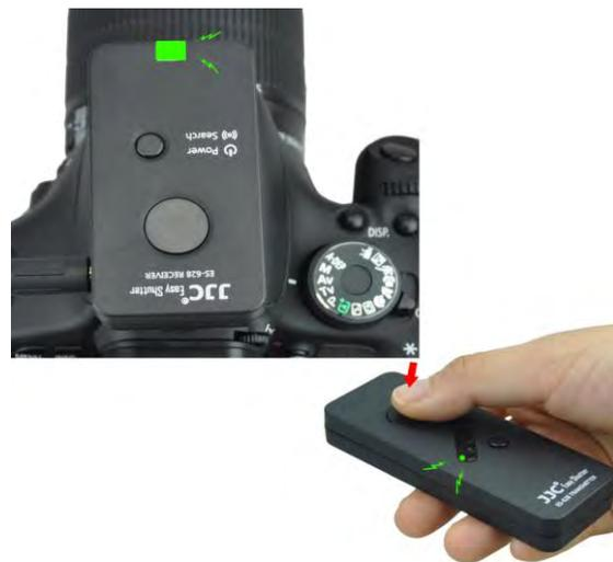
2. Drücken Sie dann die Shutter-Taste ganz nach unten. Die Kamera nimmt nach Ablauf von 5 Sekunden ein Bild auf. Sie erhalten dann ein zeitverzögertes Bild.
