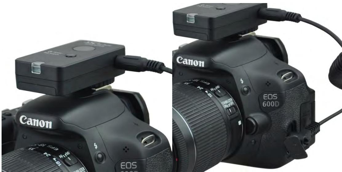
**Hinweis:** Achten Sie darauf, das Kabel richtig herum anzuschließen. Für JJC-Verbindungskabel bedeutet dies, dass Sie das in der linken Abbildung dargestellte Ende an den Empfänger und das andere Ende an den Kameraanschluss für die Fernbedienung anschließen müssen.
